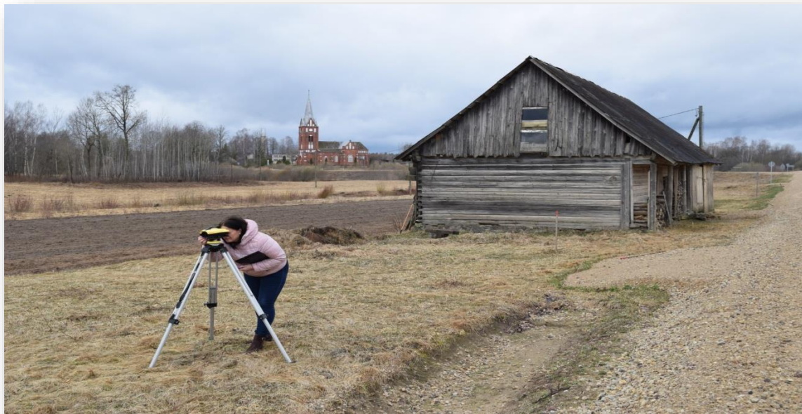
Vēsturisko līmeņa atzīmju nivelēšana pie Jēkabpils novada Dunavas pagasta „Daugaviešiem”. Foto: D. Gruberts, 2022
